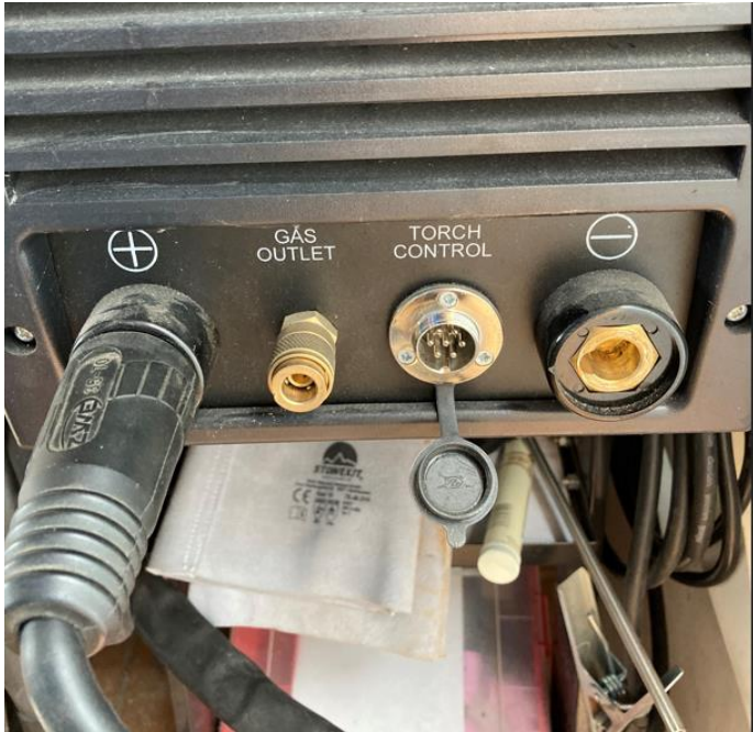
Ausgangssituation Kombigerät WIG/STICK/PLASMA Über Gas Outlet geht Schutzgas und Druckluft
