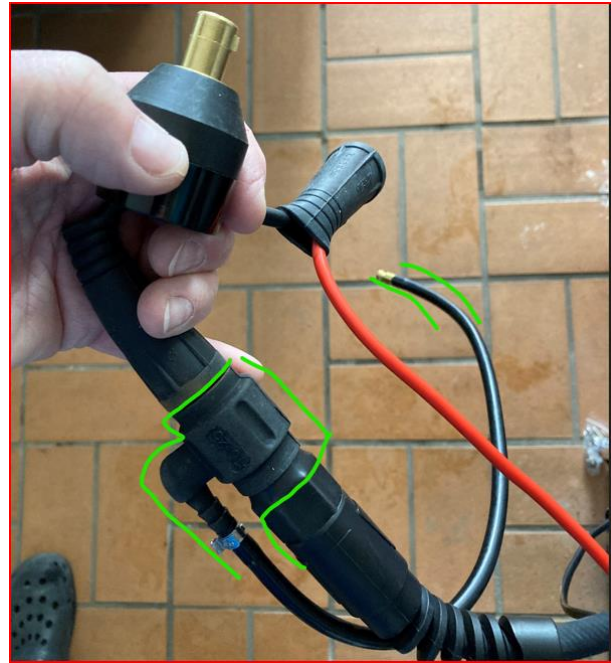
Umbausatz: 1 x Adapter 9 mm auf 13 mm (zweiter nicht benötigt und Adapter Gewinde zu Gasschnellverschluss
