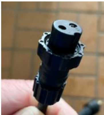
Ausgangssituation Kombigerät WIG/STICK/PLASMA Über Gas Outlet geht Schutzgas und Druckluft
